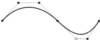
图 2-12 用路径绘制三次贝塞尔曲线
